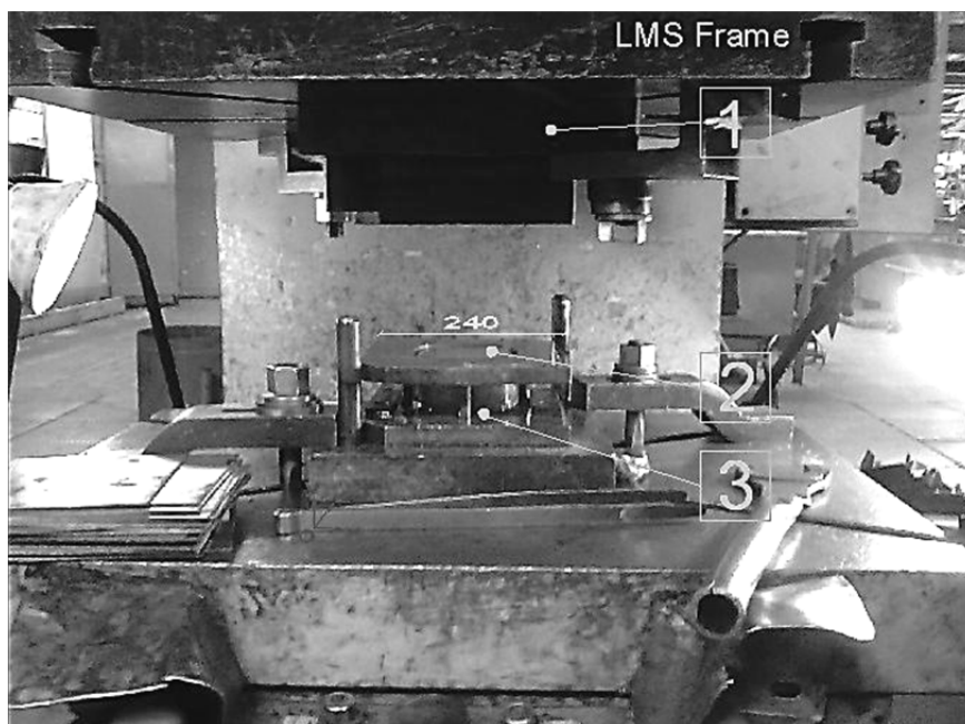
Рис. 4. Штамп для холодной листовой штамповки в штамповой зоне прессы
